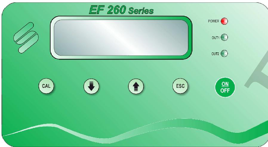
POWER LED - Зеленый свет; Медленное мигание означает, что устройство включено и функционирует нормально, в то время как быстрое мигание указывает на неисправность (отсутствие дозируемой жидкости или насос отключен)
