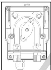
Перед выключением системы в конце сезона или выключением на длительное время, необходимо промыть трубу водой, затем установить роликовый держатель, прокрутив по часовой стрелке.
